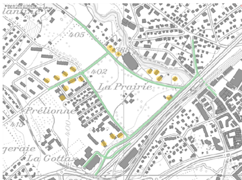
Figure 6 Bâtiments et axes pris en compte pour l'évaluation des niveaux sonores
